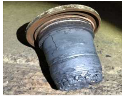
롤러 [그림14] 사고현장에서 수거한 베어링 잔해 및 엔드캡
