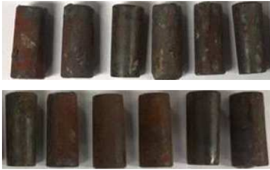
롤러 [그림14] 사고현장에서 수거한 베어링 잔해 및 엔드캡
