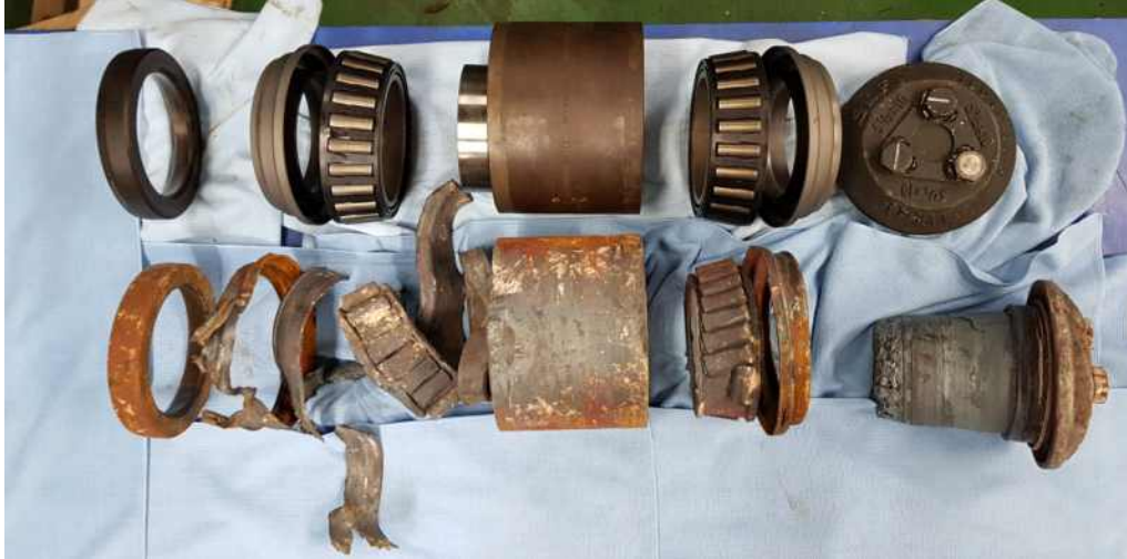
[그림10] 정상 차축 베어링(상)과 비교한 파손된 차축 베어링(하)
