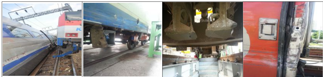
8263호 전두부 파손 8263호 배터리함 2 BOX 손상 8263호 ATS 안테나 파손 무궁화호 객차 1호 외관 손상
