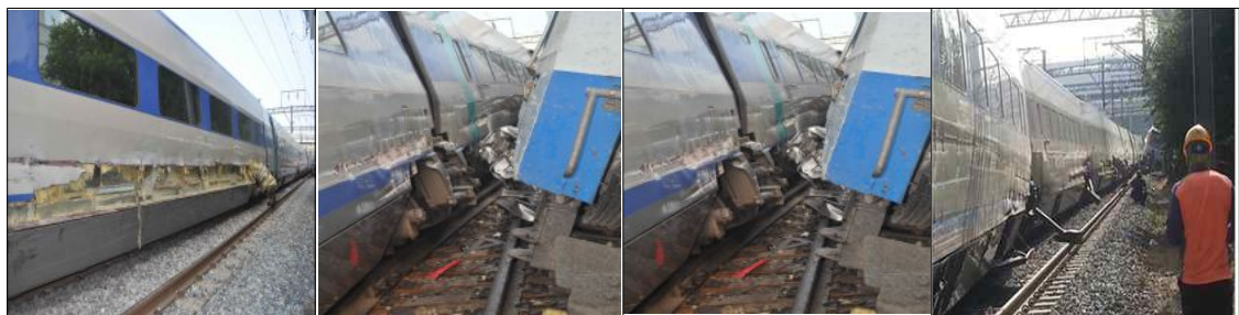
KTX33편성 5호차 차체 외관 파손 KTX 33편성 5호차 하부 파손 KTX33편성 03편성 하부 파손 상행KTX 궤도이탈 상태
