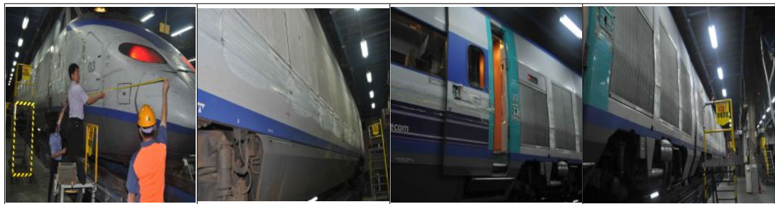
03편 PC2 차량 차체 손상 03편성 PC2 차량 차체 손상 KTX 03호 출입문 손상 편성 동력객차 그릴부 손상
