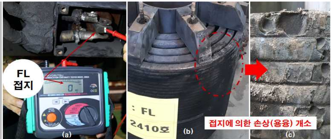
[그림 6] 필터리액터 절연파괴에 의한 소손 상태
