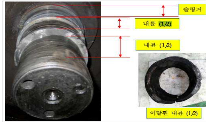
[그림9] 훼손되고 변형된 차축의 상태
