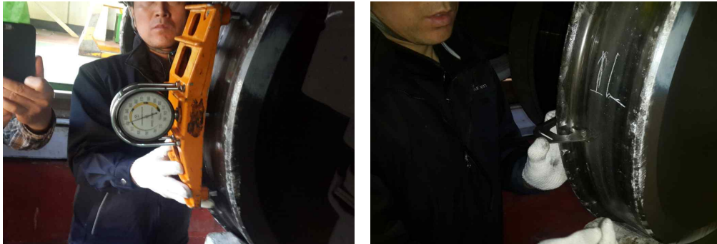
[그림 13] 차륜 직경 및 플랜지 치수 측정
