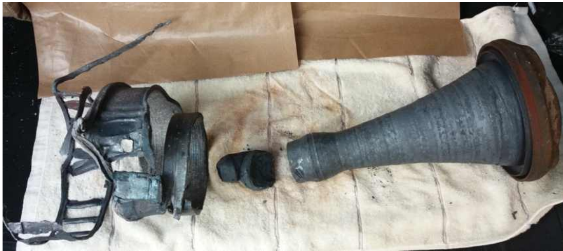
[그림 12] 사고 현장에서 수거한 차축 베어링 잔해 및 엔드캡
