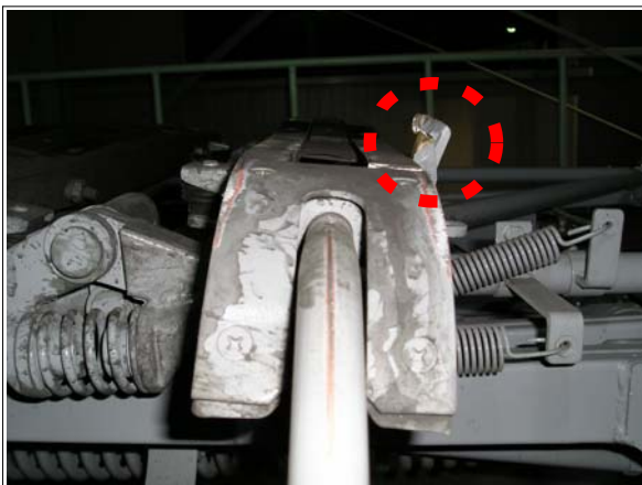
[그림10] ①번 1위 습판체 우측벨로우즈 상방향 굴곡(측면그림)
