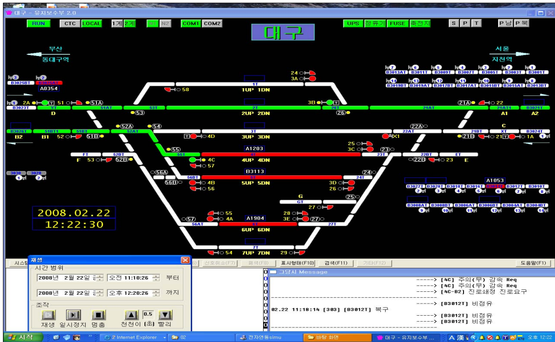
그림 8. 4번선 출발신호 구성 전자연동장치 화면
