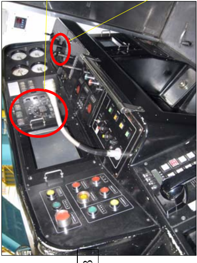
그림 5. 차상 ATC 장치 및 관련 장치
