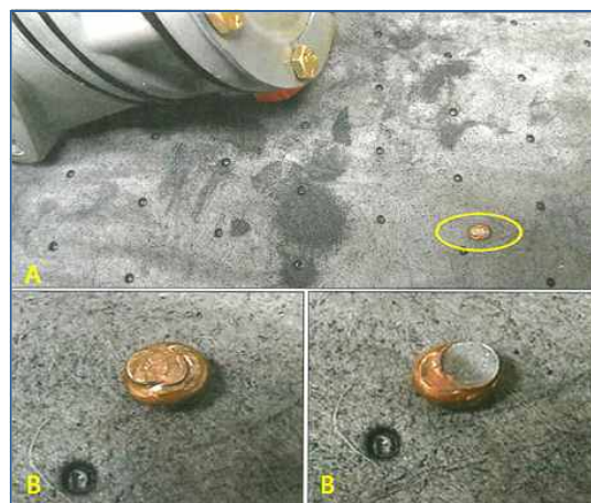
[그림 11] A: 펌프 육안점검 시 빠져나온 금속조각(노랑색 원 안) B: 금속조각 앞·뒷면 - 풀 로드의 핫 업셋 헤드
