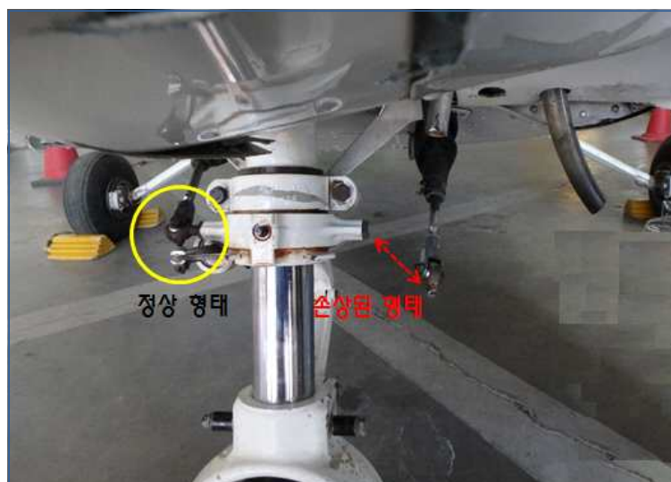
[그림 3] 앞바퀴 조향장치의 좌측연결 로드의 손상
