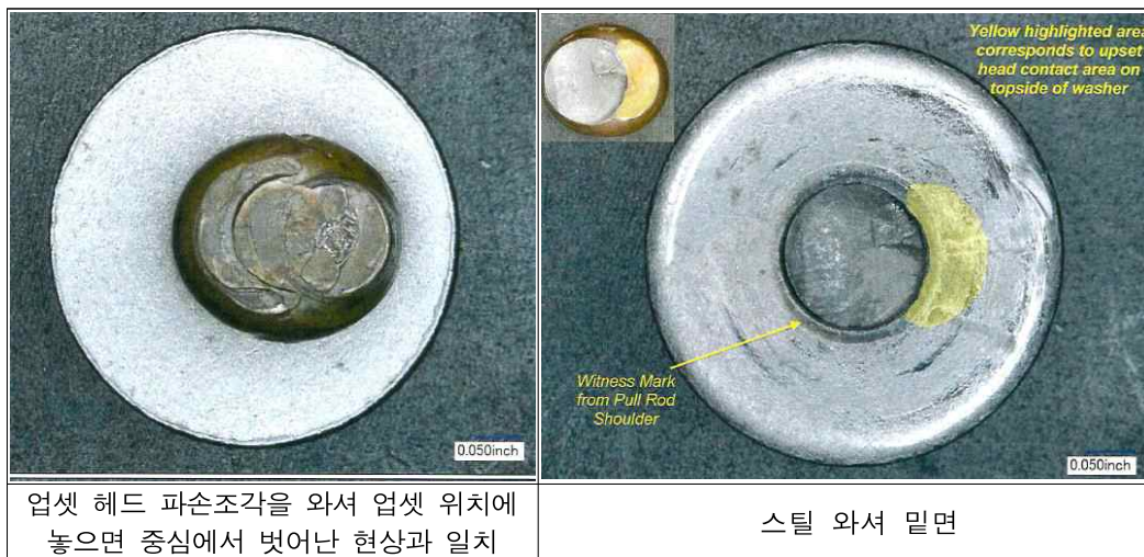
[그림16] 업셋 헤드 파손조각과 스틸 와셔 접촉면 모습
