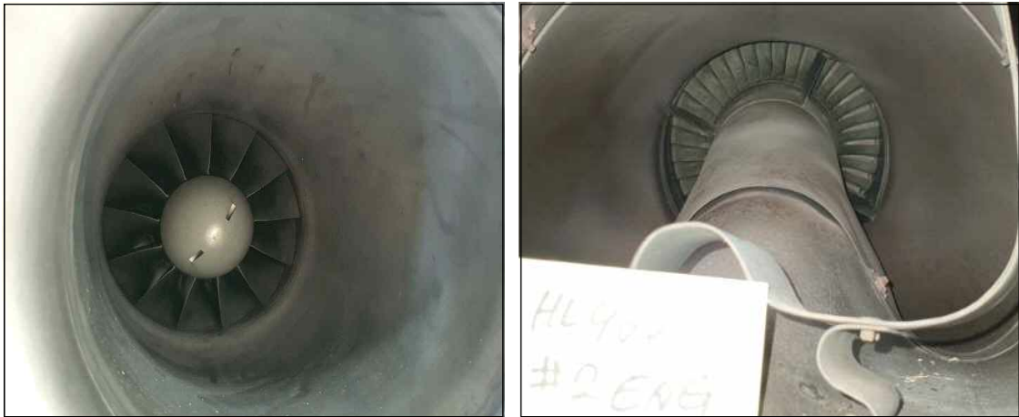
[그림 22] 우측 엔진 블레이드 및 터빈 블레이드 상태
