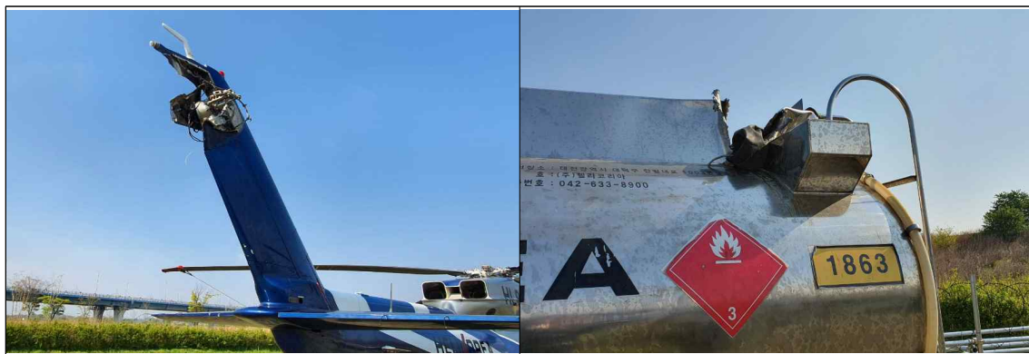
[그림 4] 꼬리회전날개 및 급유차 손상부위 사진
