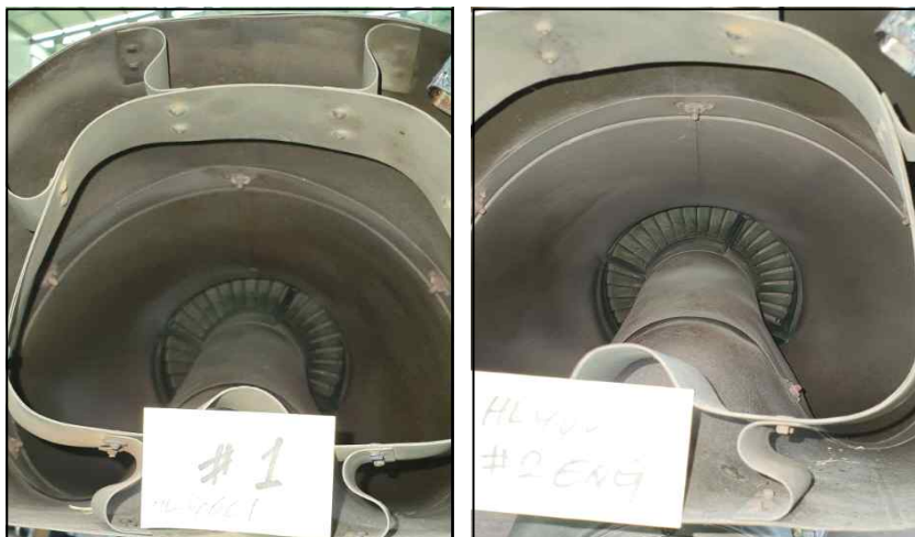
[그림 16] 좌우측 엔진 내부 상태 사진
