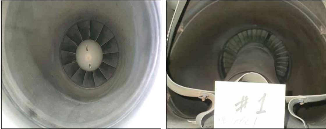
[그림 21] 좌측 엔진 블레이드 및 터빈 블레이드 상태
