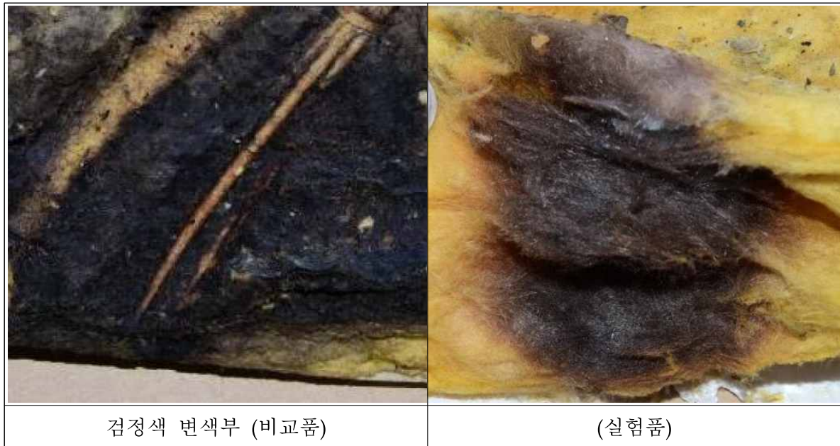
[그림 9] 열풍기를 이용한 열노출 후 변색부 비교
