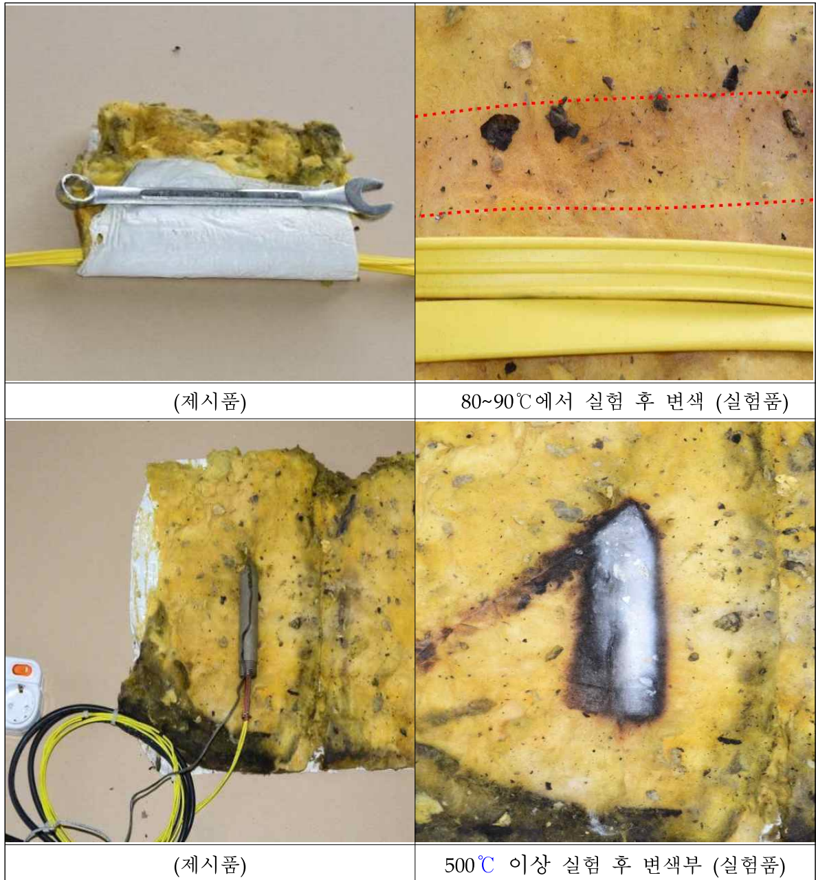
[그림 10] 열추 히터를 이용한 열노출 후 변색부 실험
