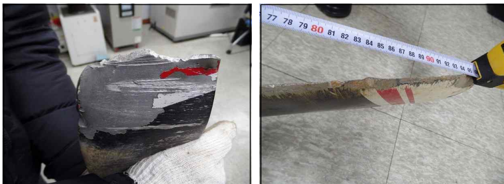
[그림 10] 프로펠러 전연부 및 끝부분 회전력에 의한 손상
