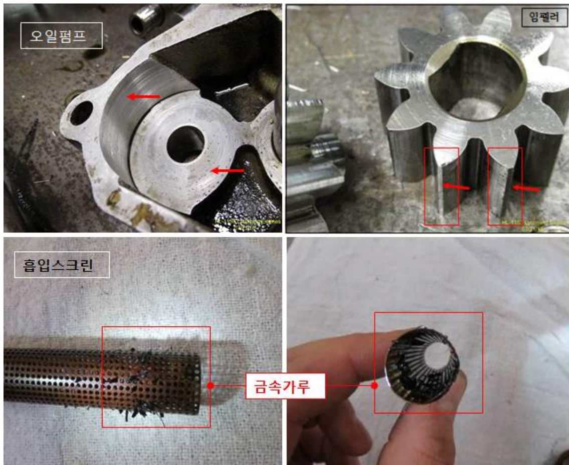
[그림 16] 오일 펌프 임펠러 및 내벽의 긁힘, 오일 흡입스크린의 오염된 금속가루
