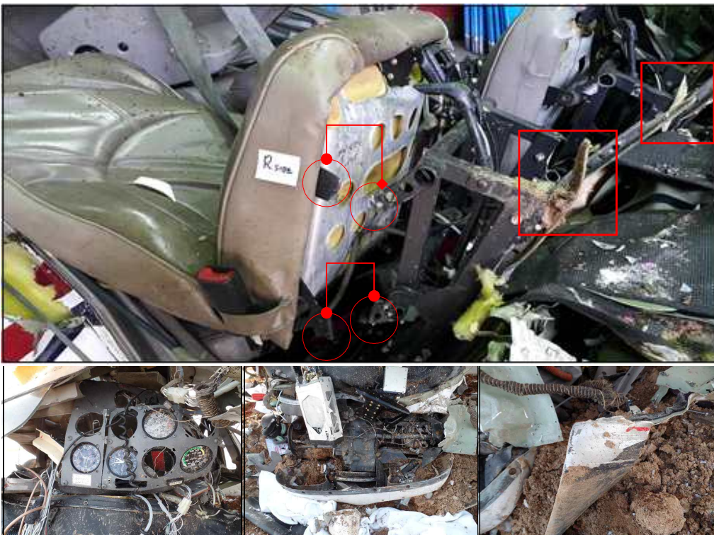
[그림 8] 전방조종석 파손 및 계기판, 엔진, 프로펠러 파손
