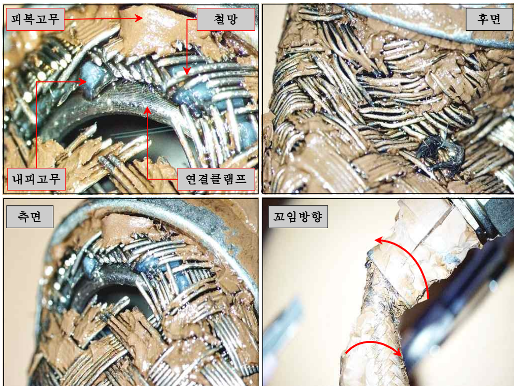
[그림 18] 오일호스 철망의 절단 모습과 꺾임 및 꼬임 현상
