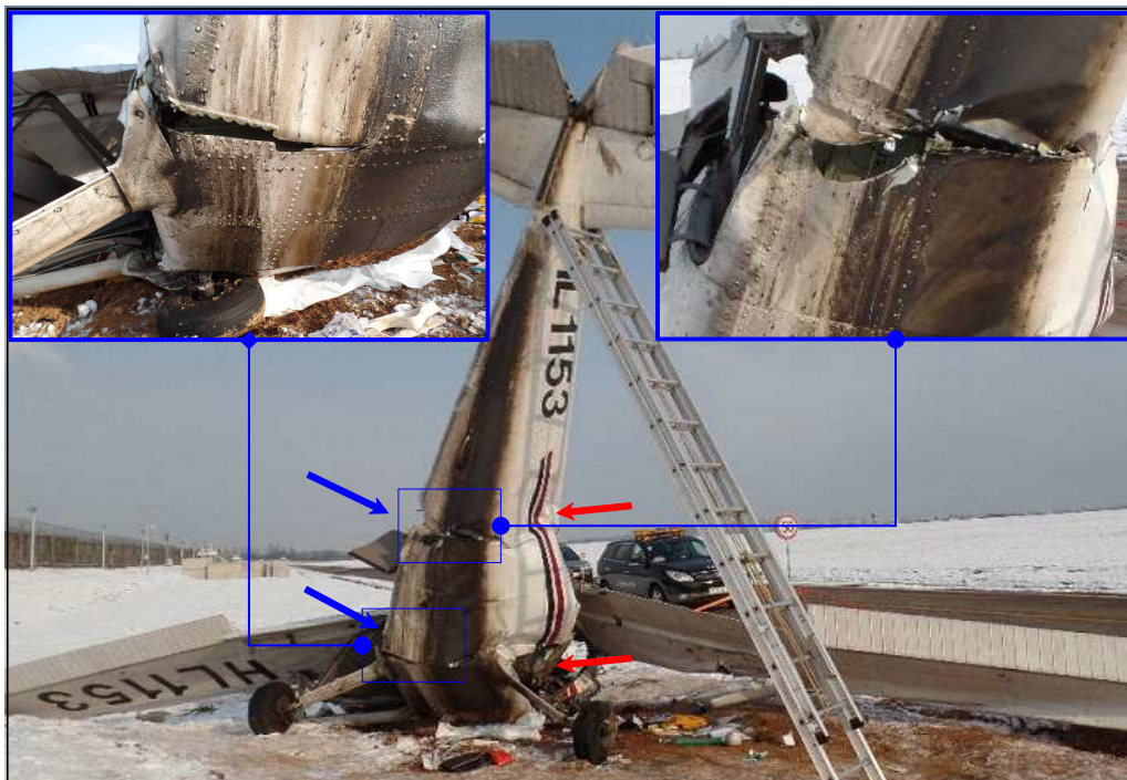
[그림 7] 추락 충격으로 압축 및 인장에 의한 손상 모습
