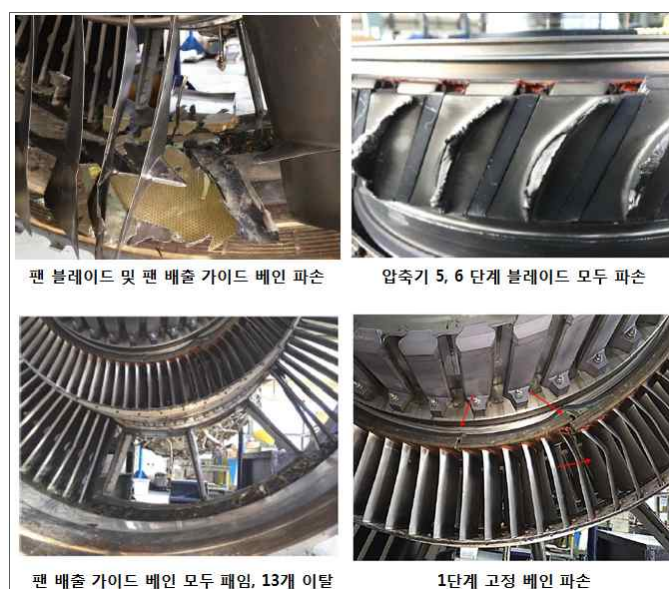
[그림 3] 4번 엔진 내부 손상 상태
