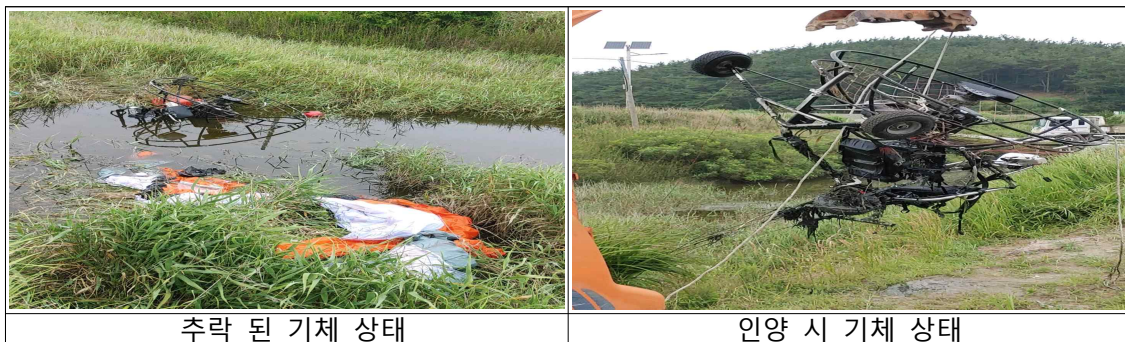
[그림 3] 추락 현장과 손상 기체 상태
