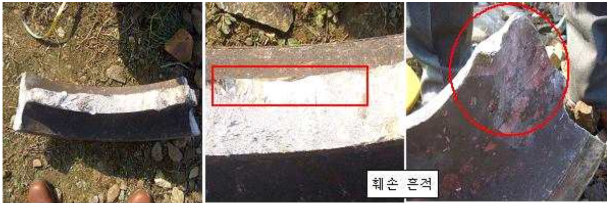
그림 11. 두 번째 파손 차륜 조각
