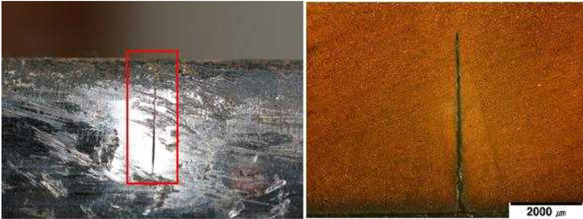
그림 16. 림 부분의 경도 저하층에서 발견된 균열
