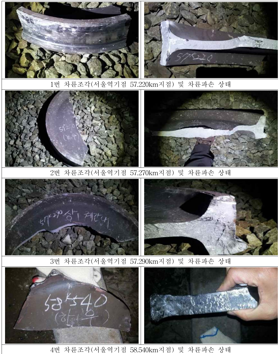
[그림7] 파손 된 차륜조각 상태
