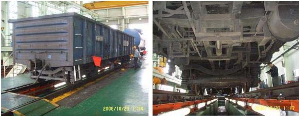
그림 6. 제동시험 중인 탈선화차
