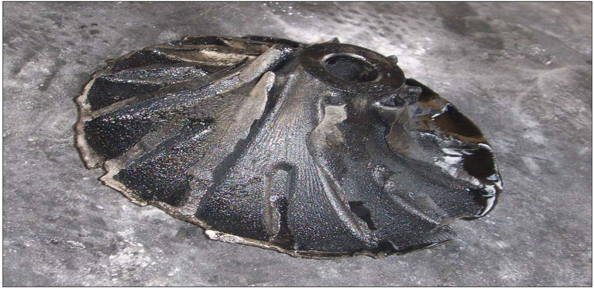
그림 15. 압축기 휠 손상 상태
