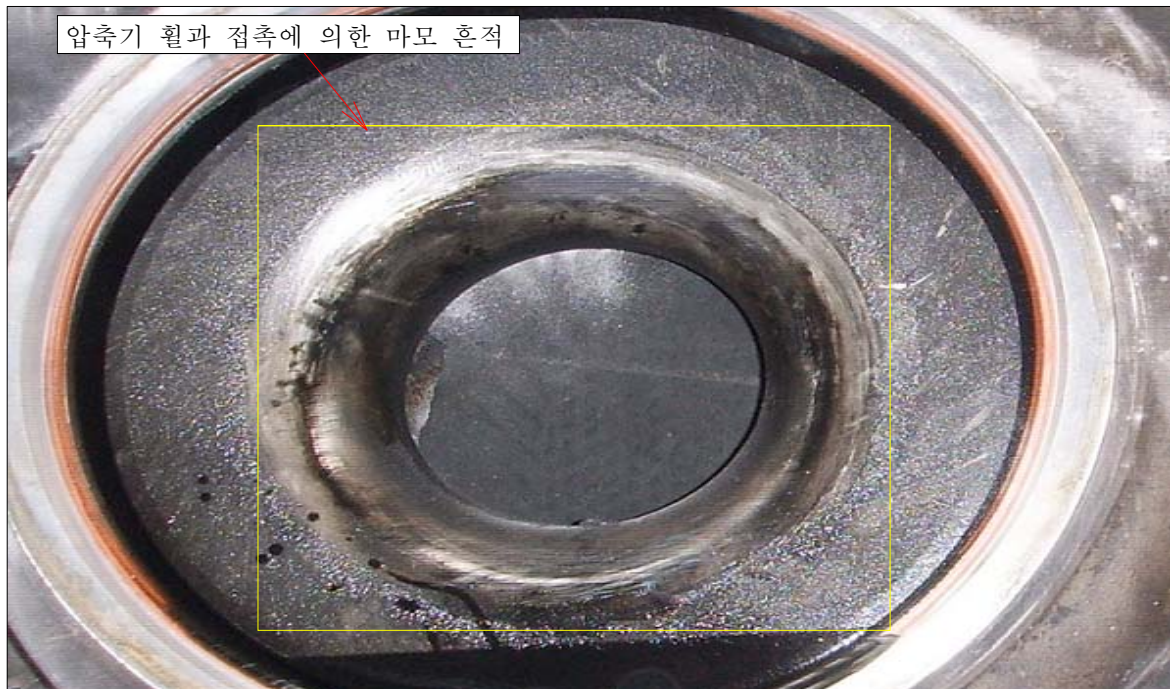
그림 16. 압축기 휠 하우징 손상 상태
