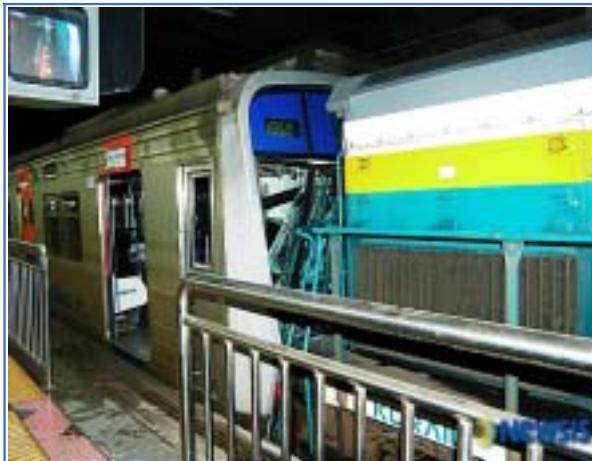
그림5. 열차추돌사고 상태 (제K1057전동열차 + 사고기관차)
