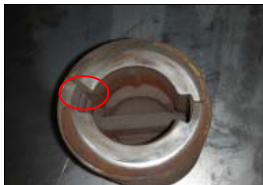
그림 5. 스너머 스프링 상부 모서리 탈락 상태
