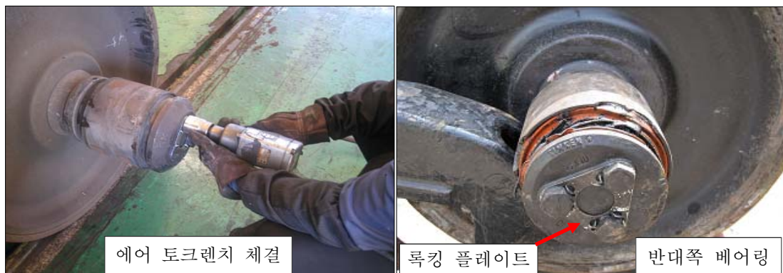
그림 17. 엔드 캡 볼트 체결과정 및 반대쪽 엔드 캡
