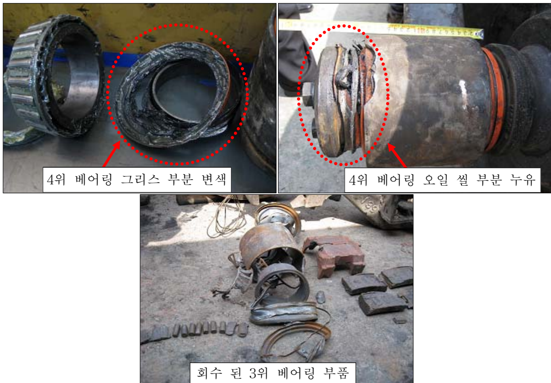
그림 7. 2위 차축 4위 베어링 상태 및 회수 된 3위 베어링 부품
