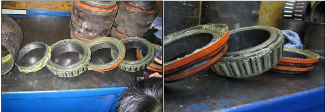
그림 16. 같은 차축 반대쪽 베어링 상태
